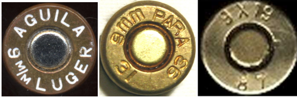
Tres culotes del mismo calibre, el 9 m/m Parabellum y tres modos distintos de denominarlos
